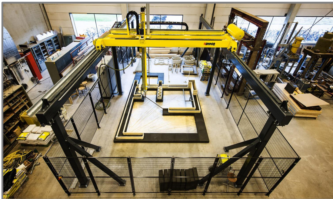
Obr. 5.1 Portálová konstrukce velkorozměrové 3D tiskárny [4]
