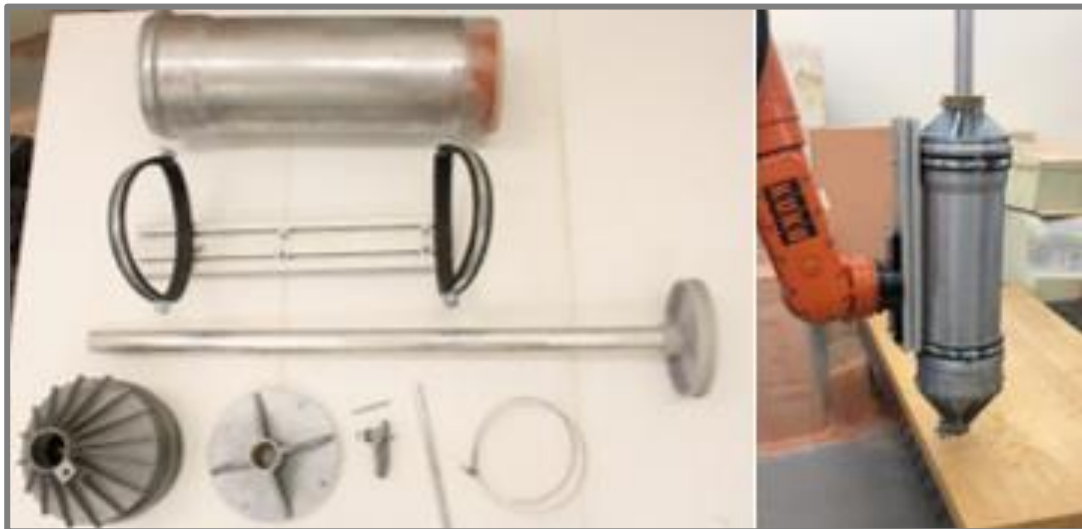
Obr. 9.3 Pístová tisková hlava: a) Prvočinitele hlavy, b) Pracovní pozice hlavy [autor]
