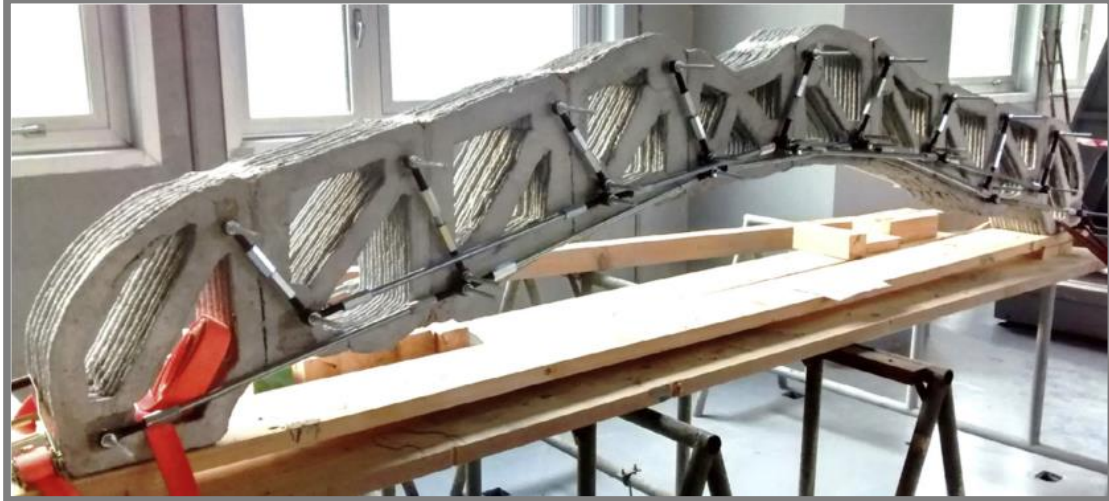
Obr. 5.22 Vnější systém výztuh [24]
